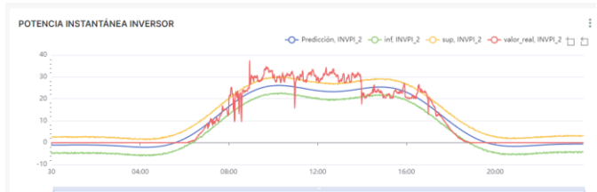
Figura 6. Tercer modelo, ejemplo de predicciones potencia instantánea de un inversor
