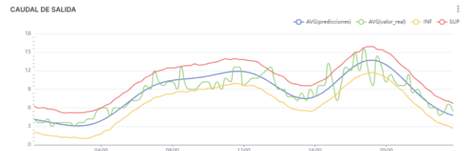
Figura 4. Tercer modelo, predicciones caudal de salida de un depósito de almacenamiento
