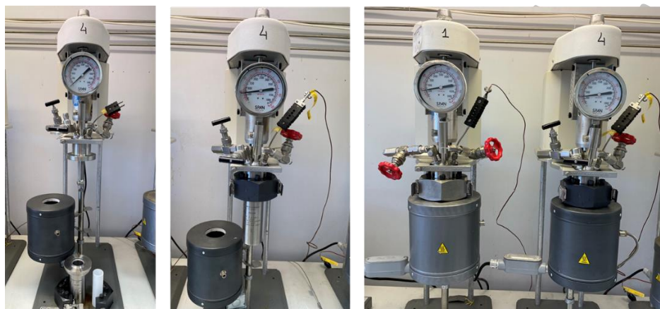
Figura 34. Reactores de alta presión empleados para llevar a cabo las reacciones de oxidación de benceno a fenol.
