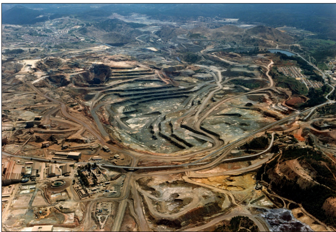
Figura 3. Vista aérea actual de la corta de Cerro Colorado y de parte de las instalaciones de las minas de Riotinto. En la imagen se observa como el Cerro Colorado (ver figura 2), está totalmente explotado, y unidas las antiguas cortas de Filón Sur y Filón Norte, constituyendo una de las mayores, si no la mayor explotación a cielo abierto de la provincia de Huelva. En ella, además del gossan para obtención de Au y Ag, se explotó extensamente la mineralización de "stockwork" para Cu, de la que todavía existen importantes reservas. Foto cedida por E. Romero.
