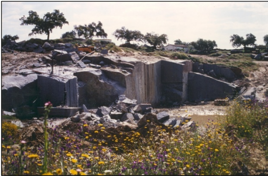
Figura 6. Cantera de granito para la extracción de bloques en Santa Olalla de Cala. Fotografía de J.C. Fernández Caliani.
