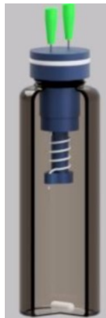
Fig.II.5 HF en espiral (SHF). Espacio de cabeza
