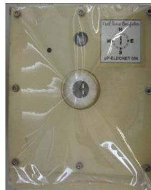
Figura 12. Radiómetro Eldonet empleado en la evaluación de la atenuación relativa de la irradiancia PAR.
