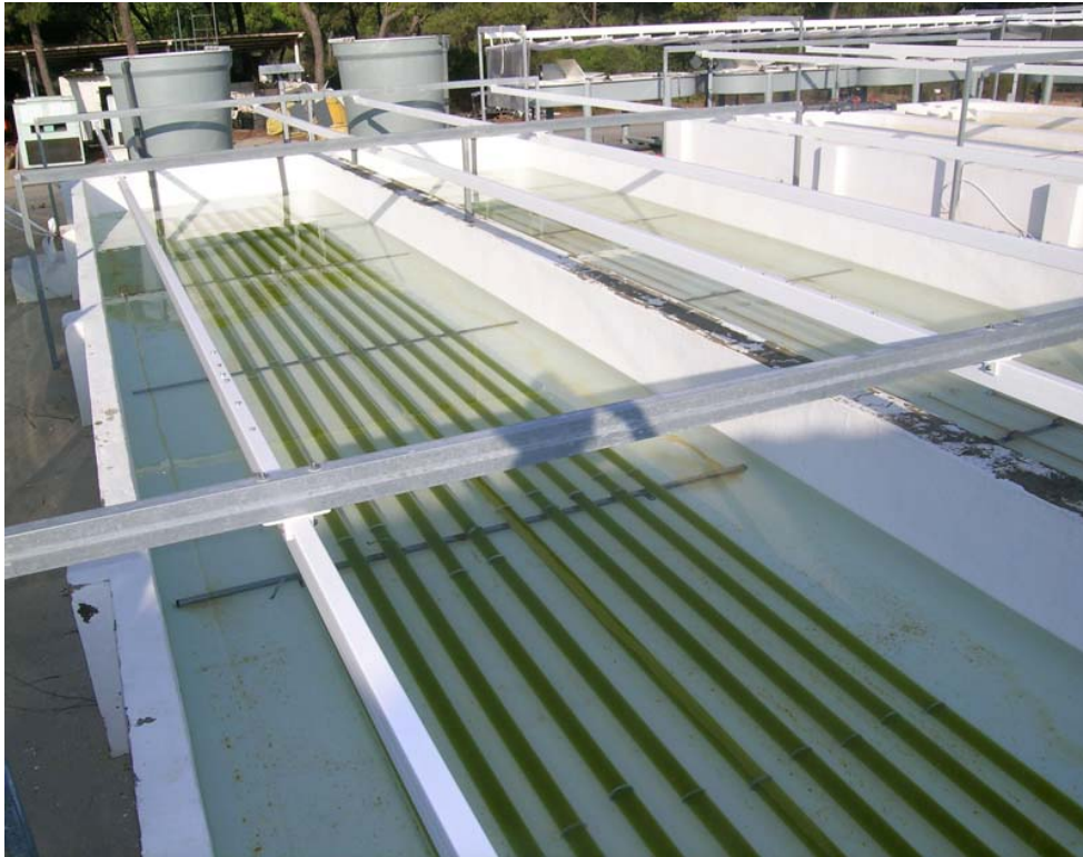
Fotobiorreactores tubulares de 400 l instalados en la planta piloto experimental ubicada en el Centro para la Investigación del Cultivo de Especies Marinas (CICEM - "Agua del Pino").
