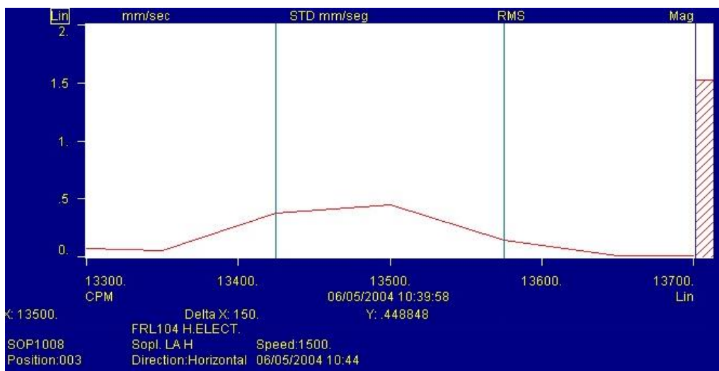
Figura 14. Intervalo de medida de la frecuencia ÁLABES en la posición 3 eje horizontal en términos de RMS (mm/s).
