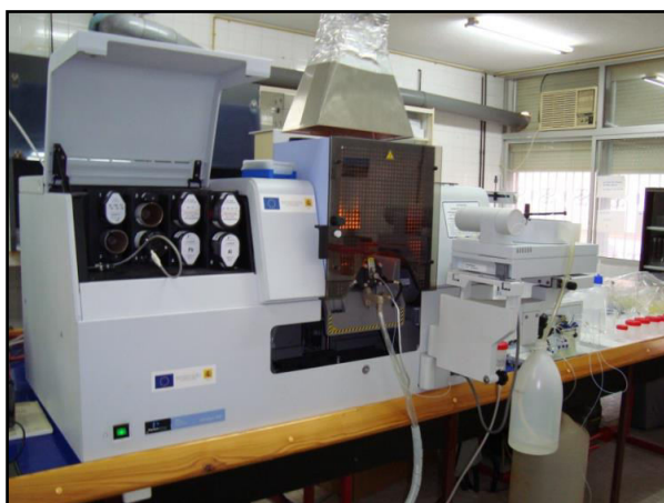
Figura 4.6 Absorción Atómica Perkin-Elmer AAS (AAAnalyst 800)
