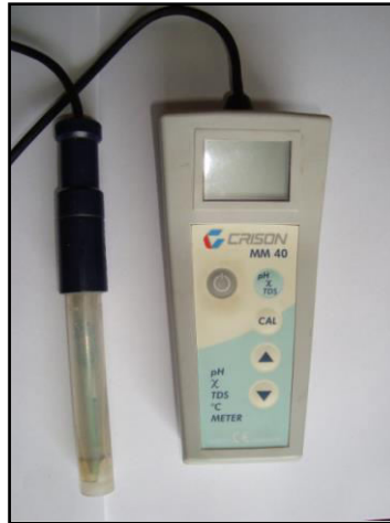
Figura 4.3 Equipo multiparamétrico CrisonMM40
