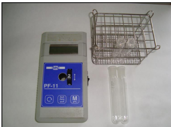
Figura 4.5 Fotómetro para análisis de sulfatos
