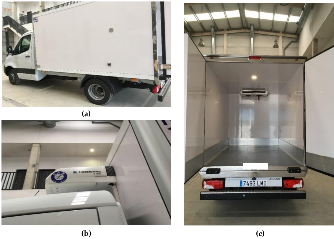
Figura 4. 11. (a) Detalle del camión frigorífico ligero; (b) Sistema de refrigeración eléctrico; (c) Nevera isotérmica.
