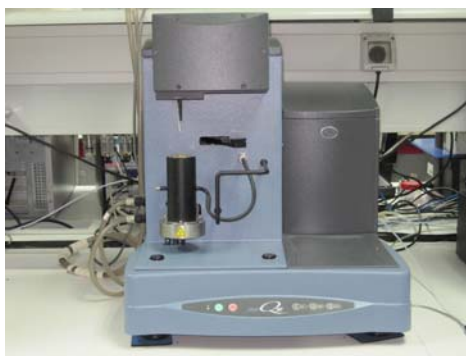
Figura III.11 Analizador Termogravimétrico (TGAQ-50).
