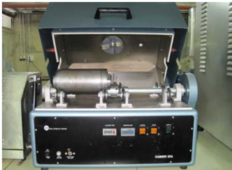
Figura III.9 Roll Stability Tester modelo 1940-3 (Stanhope-Seta, Gran Bretaña).
