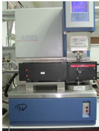
Figura III.5 Reómetro de deformación controlada ARES.
