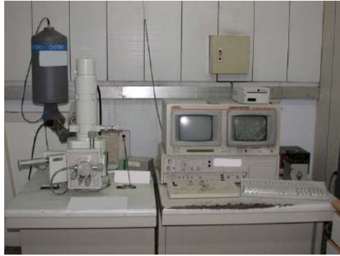
Figura III.7 SEM modelo JSM-5410.
