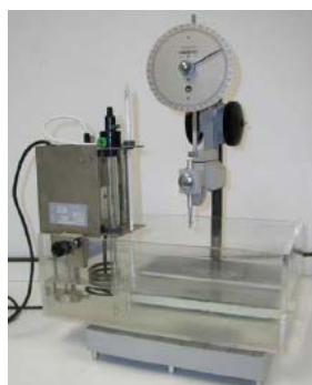
Figura III.8 Penetrómetro modelo Seta Universal Penetrometer 17000-2 (Stanhope-Seta, Gran Bretaña).
