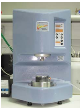
Figura III.4 Reómetro de esfuerzo controlado Gemini BOHLIN.
