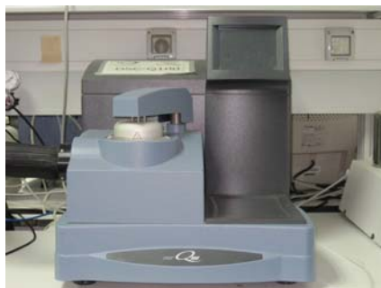
Figura III.10 Calorímetro diferencial de barrido (DSCQ-100).
