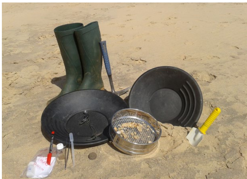
Fig. 2. Selección de herramientas básicas para el bateo.
