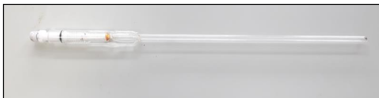
Tubo de RMN de presión empleado en estos experimentos.
