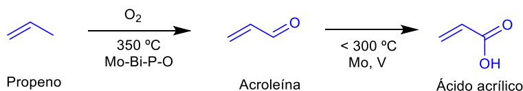
Esquema 1. Síntesis industrial del ácido acrílico mediante oxidación directa de propeno.
