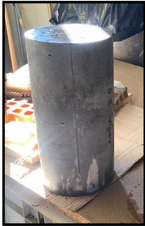
Imagen 09: Preparación y secado de probetas para el ensayo
