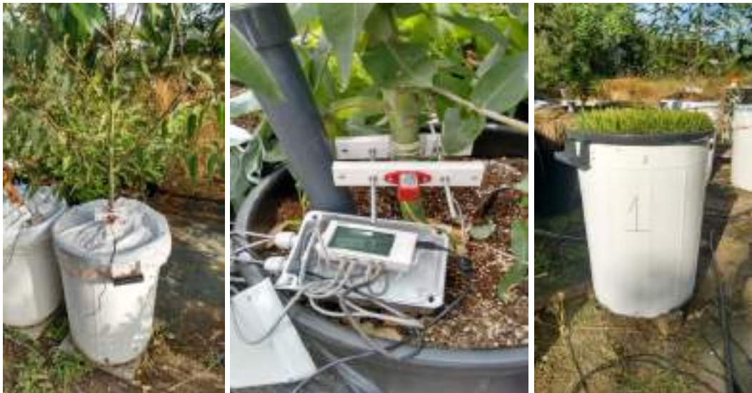
Figura 4.7. (izda.) Detalle de las plantas crecidas en contenedores de 100 L. para cuantificación del consumo de agua y el crecimiento a distintos niveles de disponibilidad hídrica; (centro) Dendrómetro electrónico de desplazamiento lineal y registrador acoplado; (dcha.) Contenedor con hierba gramínea recortada a 12 cm de altura tomada como referencia para comparación con la transpiración de las plantas.
