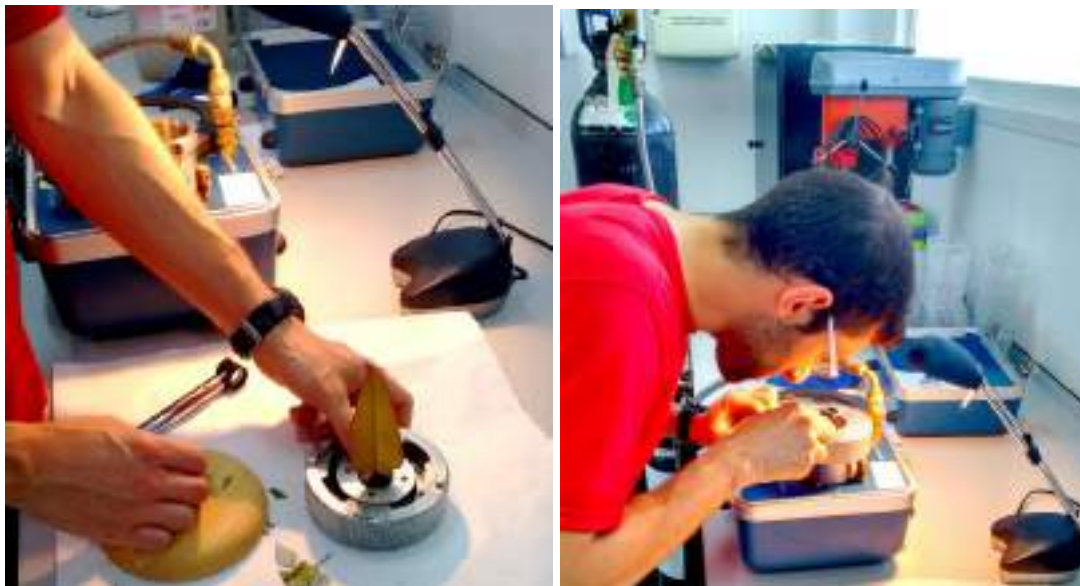
Figura 4.4. Medición del potencial hídrico xilemático ( \Psi ) con cámara de presión.
