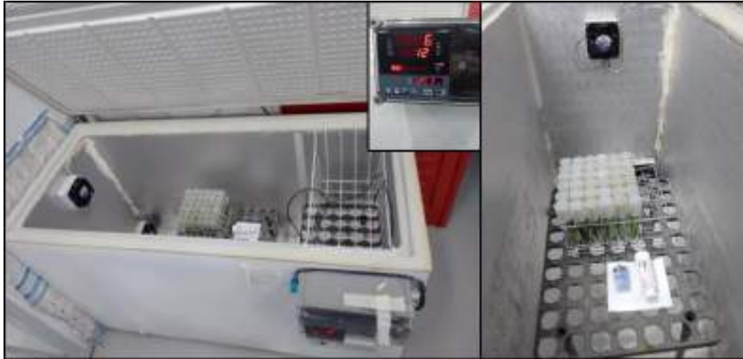
Figura 5.1. Detalle de la disposición de las hojas dentro del arcón congelador con regulador de temperatura y temporizador acoplado, ventiladores interiores y termómetros registradores.
