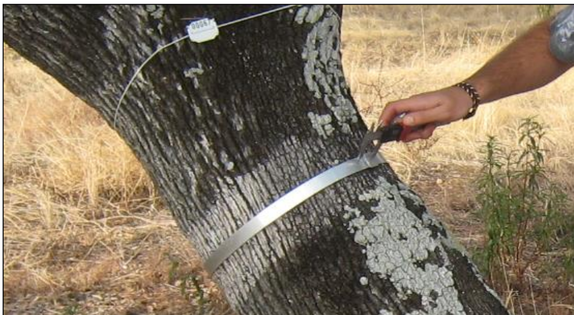
Fig. 3.2 Detalle de la medición de un dendrómetro de banda en la parcela SB. Autor: Daniel Martín Pérez
