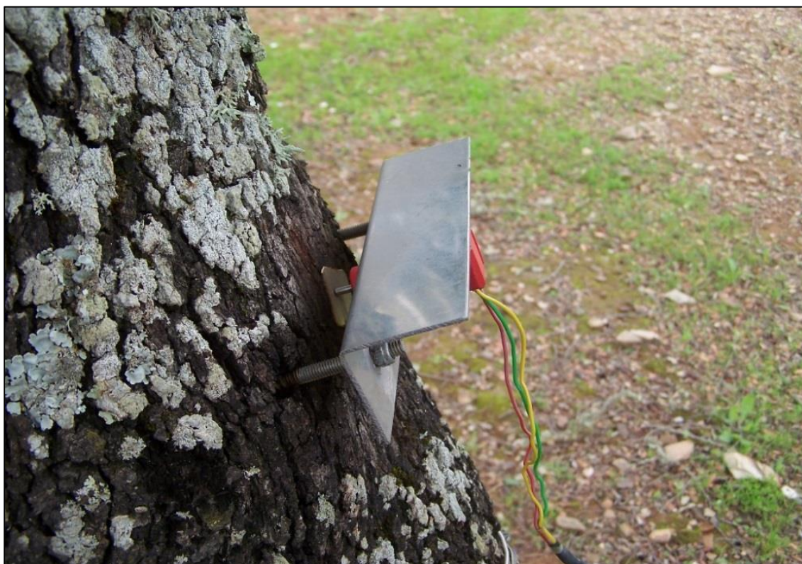
Fig. 3.3 Detalle del sensor de un dendrómetro electrónico en la parcela HR. Autor: Daniel Martín Pérez
