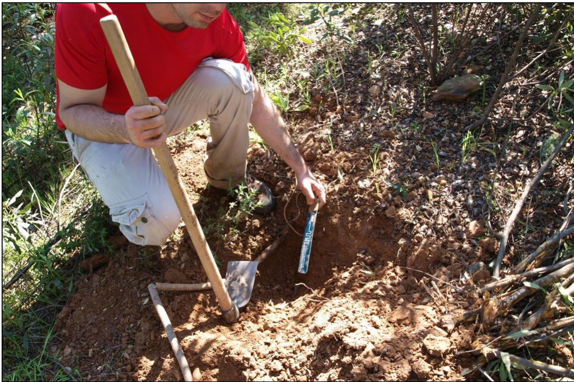
Fig. 3.4 Instalación de un sensor de humedad de suelo en HR. Autora: Reyes Alejano
