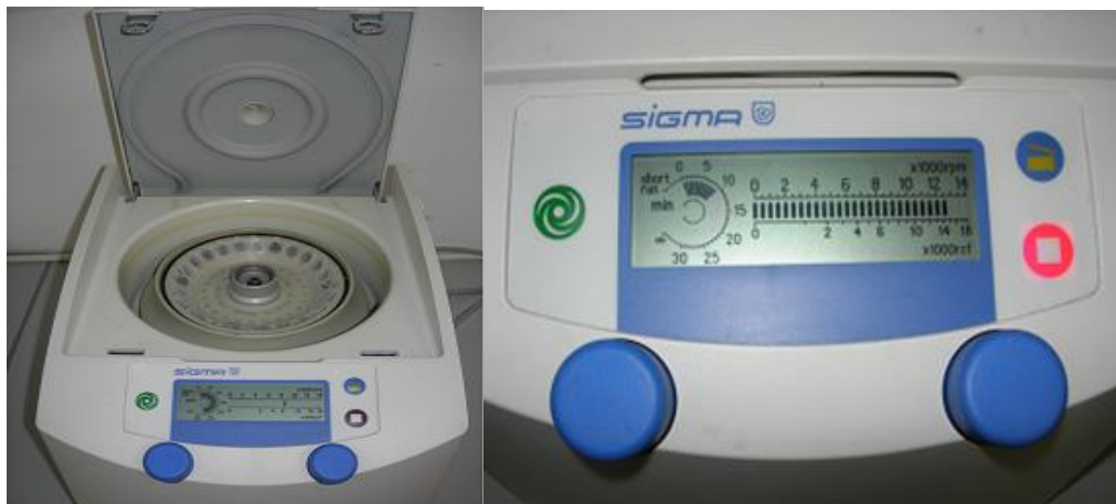
Figura 41.- Microfuga y detalle de su panel de mandos
