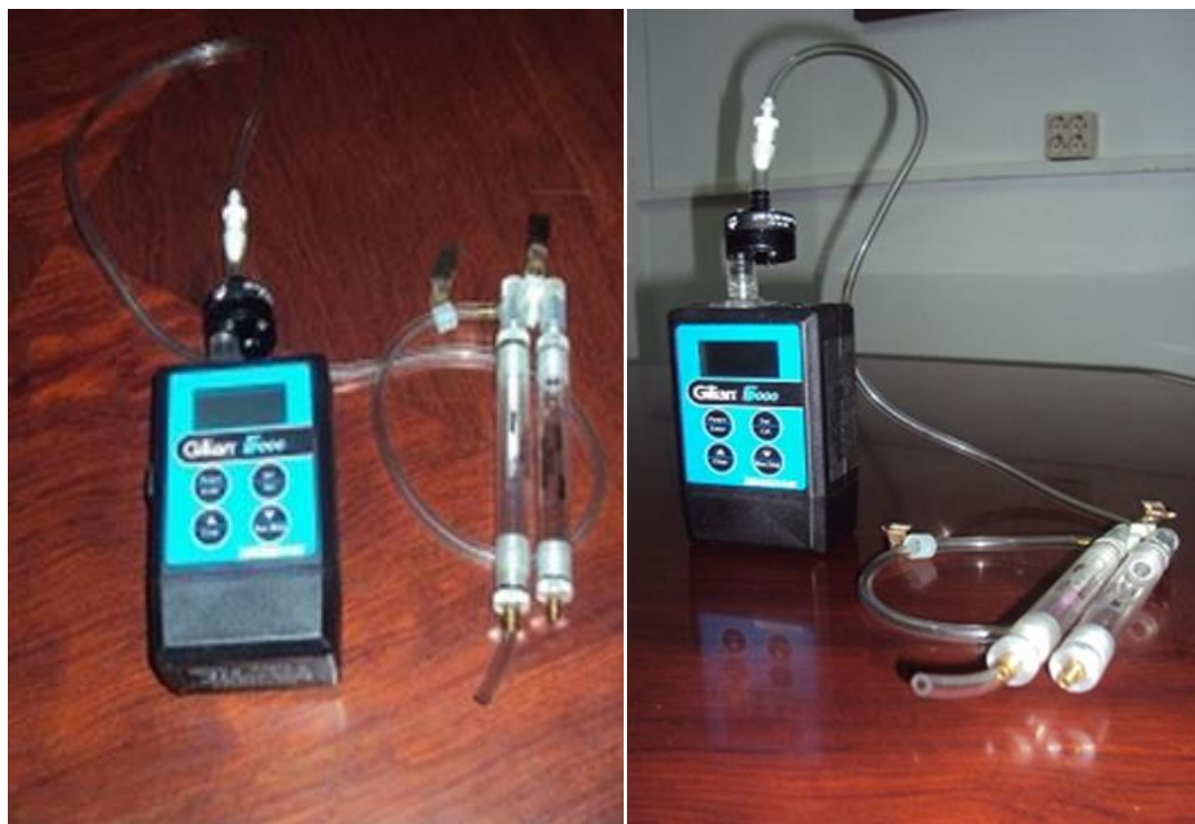
Figura 21.- Fotos del tren de muestreo utilizado, con dos tubos para captación de dos contaminantes simultáneamente.
