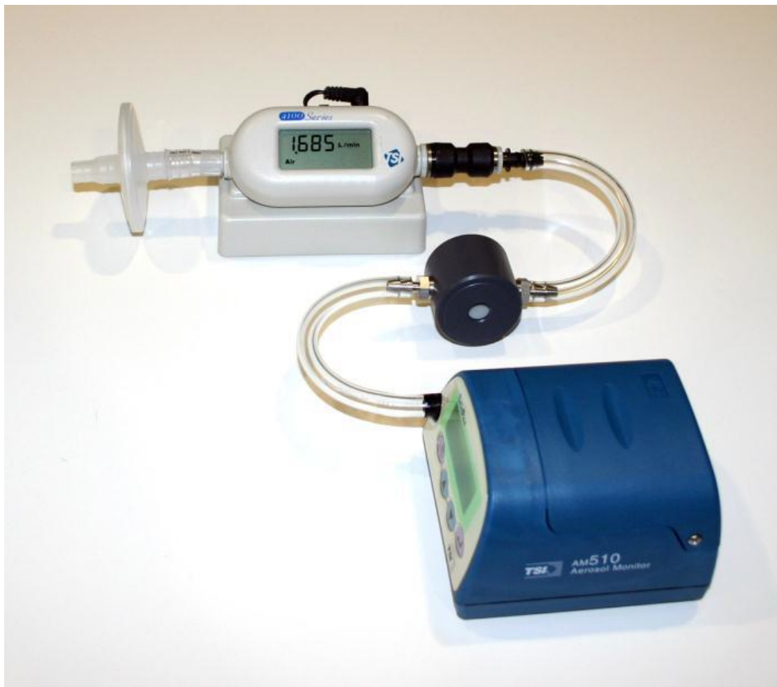
Figura 18.- Calibrador de campo TSI, conectado una bomba para su calibrado.
