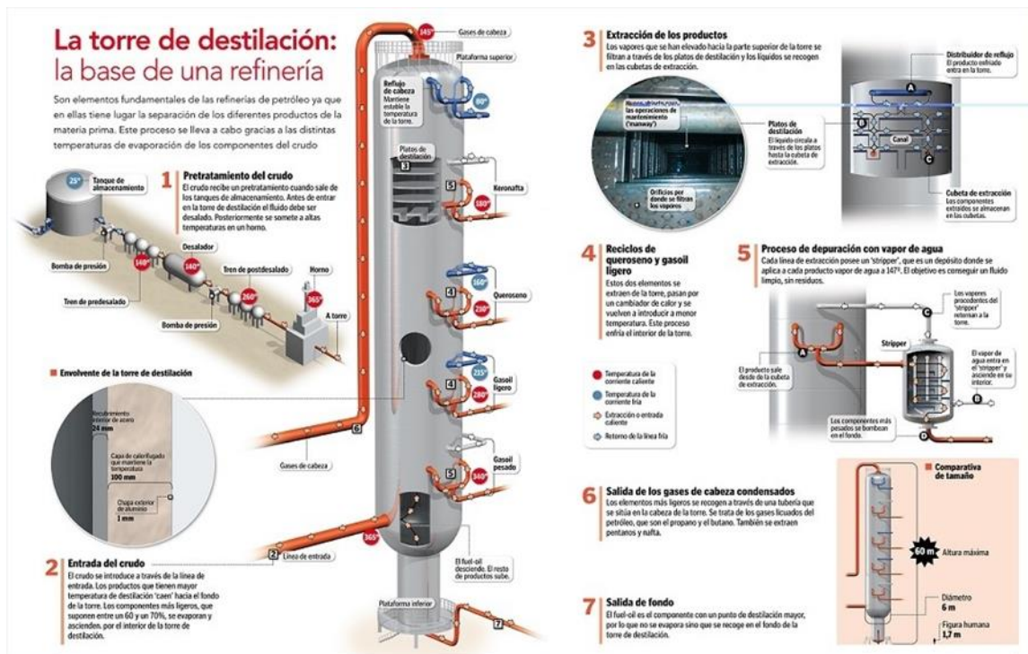
Figura 1.- Torre de destilación y subproductos que se obtienen del crudo Fuente: www.cepsa.com
