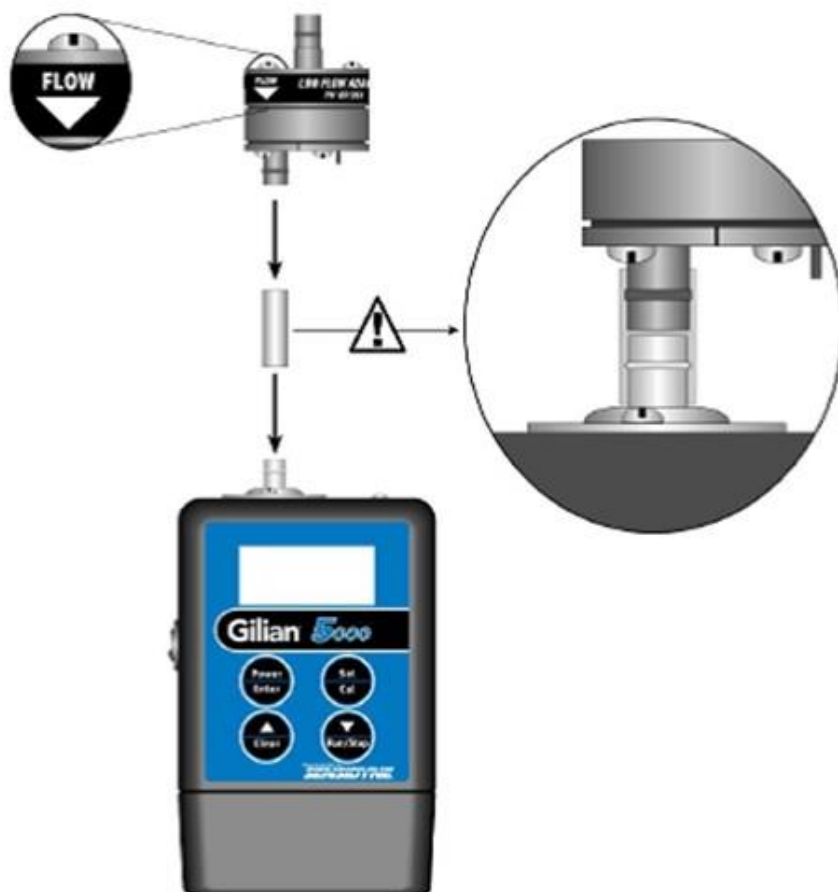
Figura 19.- Adaptador de bajo caudal, conexión a bomba Gillian 5000.
