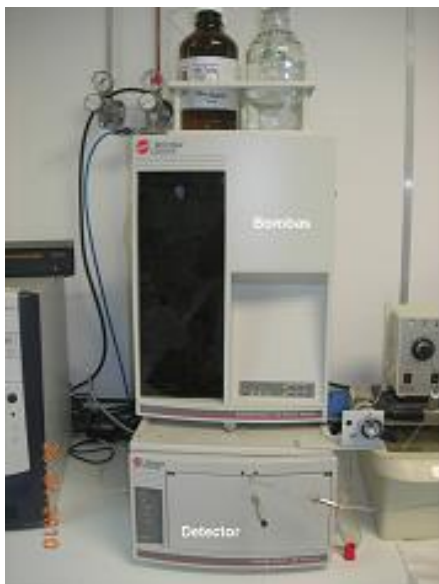
Figura 25.- Sistema de bomba y detector.
