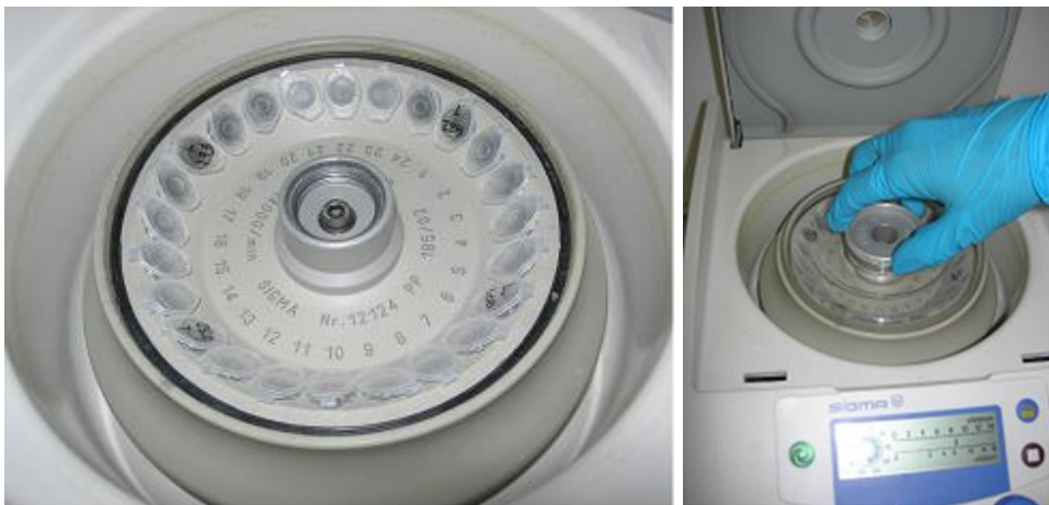
Figura 40.- Ubicación de eppendorf en la microfuga y cerrado de la cubierta
