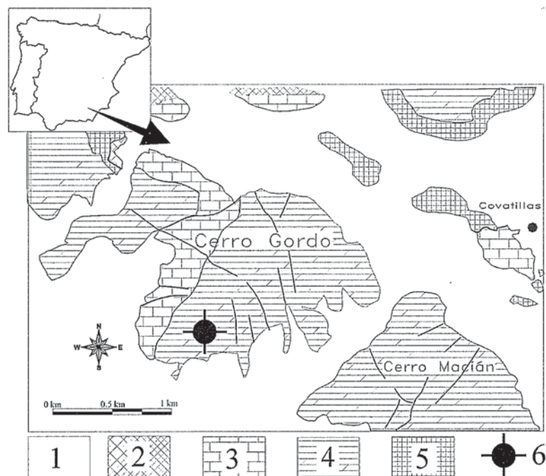
Fig. 1. Contexto geológico de la zona de los sondeos de las dolomías brechoides estudiadas. 1: Cuaternario. Arenas, gravas y conglomerados. 2: Mioceno superior. Calizas con algas y calizas arenosas. 3: Cretácico inferior. Margas verdes y margocalizas grises. 4: Jurásico (Sinemuriense - Pliensbachense). Calizas y calizas dolomíticas. 5: Retiense - Hettangiense. Dolomías y calizas dolomíticas. 6: Ubicación de los sondeos.
