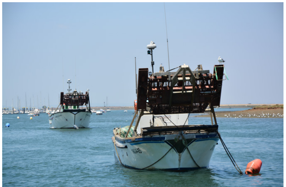
Embarcaciones equipadas con dragas hidráulicas para chirlas en Isla Cristina (Huelva)
