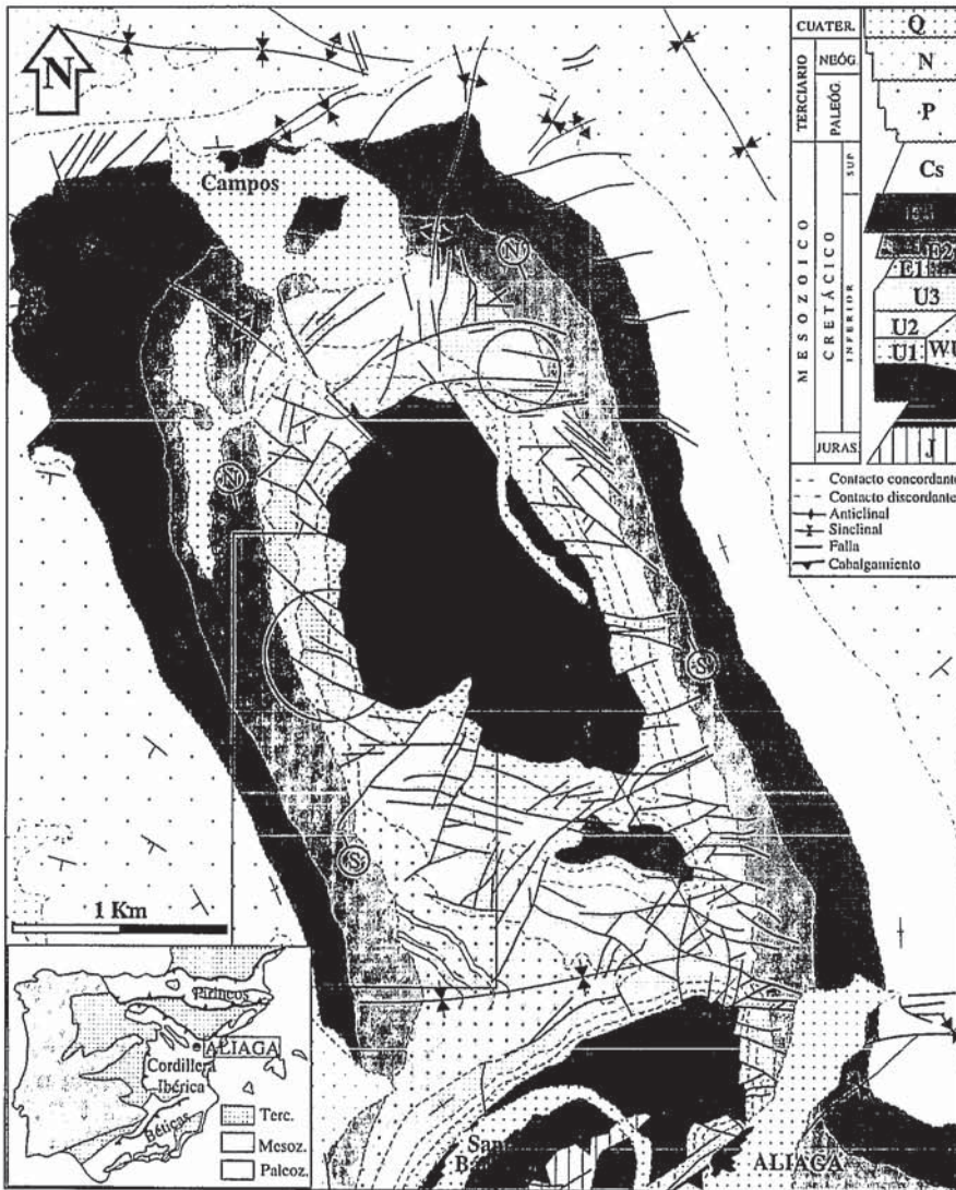
Fig. 1.- Mapa geológico del anticlinal de Campos-Aliaga y la red de fallas del Cretácico Inferior (Hoja nº 518, Montalbán, del M.T.N. 1:50.000). J: Jurásico; W1: Fm. El Castellar; W2: Fms. Camarillas y Artoles; WU: depósitos detríticos sustitutos de la parte inferior del Urgon; U1: Fm. Chert; U2: Fm. Forcall; U3: Fm. Villarroya de los Pinares; E1: Miembro inferior de la Fm. Escucha; E2: Fm. Escucha; E3: Fm. Utrillas; Cs: Cretácico superior; P: Paleógeno; N: Neógeno; Q: Cuaternario. Se señala la situación de la fotografía aérea de la figura 2 (rectángulo), las áreas donde se han tomado datos de afloramiento (círculos) y los cortes de la figura 4 (N-S y N'-S').
