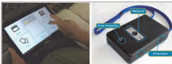
Figura 3. Dispositivos interfaz: la tableta (izquierda) y el prototipo DCPAR (derecha).
