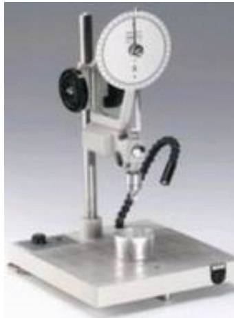
Figura 2- 15. Ensayo de penetración
