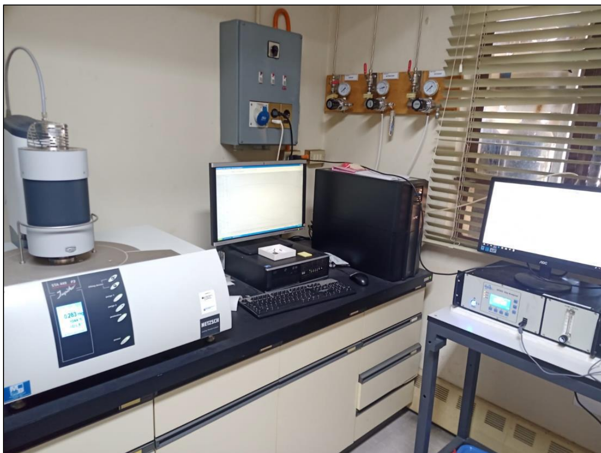
Figura VI. 1: Equipos utilizados para la realización de la prueba de termogravimetría. De izquierda a derecha: Termogravímetro, ordenador de registro de resultados, control de atmósfera gaseosa, equipo DOAS de análisis de gases de salida.
