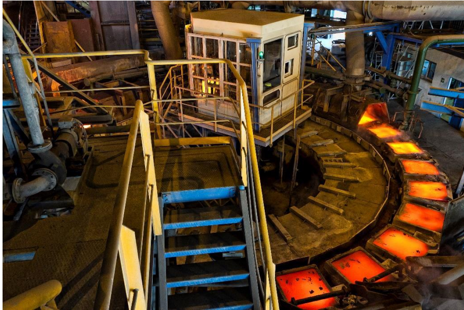
Figura I. 13: Rueda de moldeo giratoria ánodos de la planta de Atlantic Copper.
