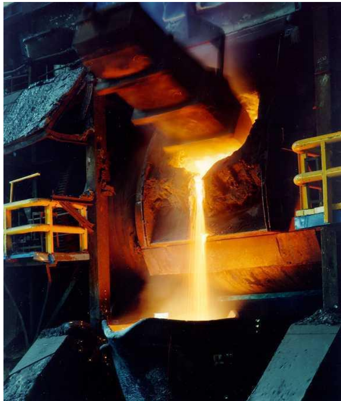
Figura I. 9: Proceso de carga de un convertidor Peirce-Smith mediante caja.
