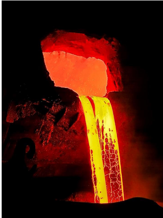
Figura I. 10: Escoriado de un convertidor mediante vertido por la boca hacia una cuba para su envío a la recuperación de mata en un horno eléctrico.
