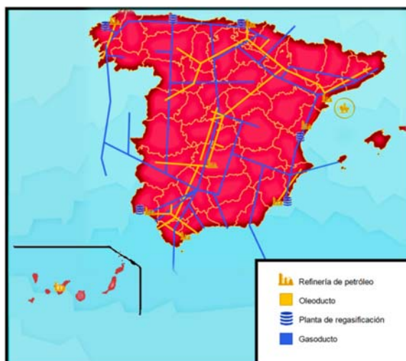
Figura 1. Red básica de oleoductos y gasoductos en España. Fuente: Elaboración propia con datos de GN Fenosa y Grupo CLH.
