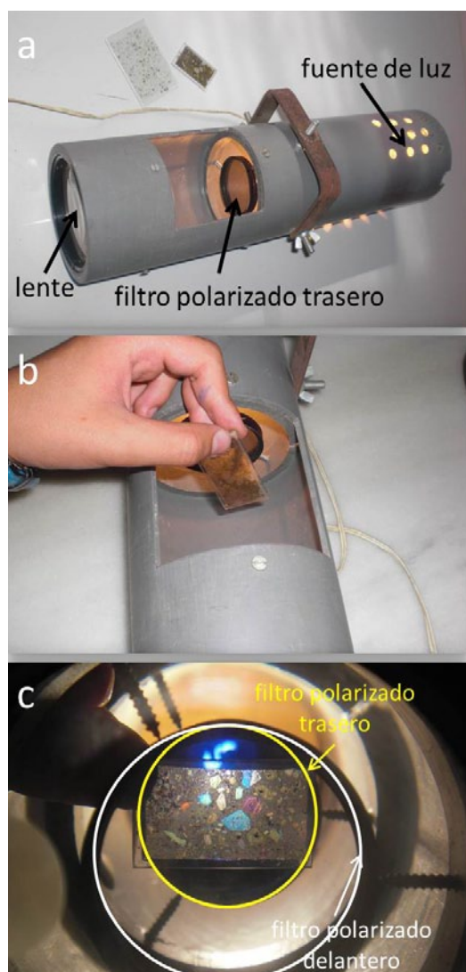
Fig. 6. a) Instrumento elaborado con un tubo de material rígido al que se le incorporan dos filtros de polarización (en la foto solo visible el trasero), una lente en uno de sus extremos y un foco de luz. b) Las láminas delgadas se introducen a través de un orificio situado entre ambos filtros. c) Al estar los dos polarizadores cruzados se observan los colores de interferencia que poseen estos minerales.
