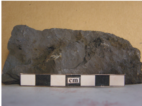
Figura 5-6 Muestra de mano de la litofacies calcítica del gossan de Las Cruces.
