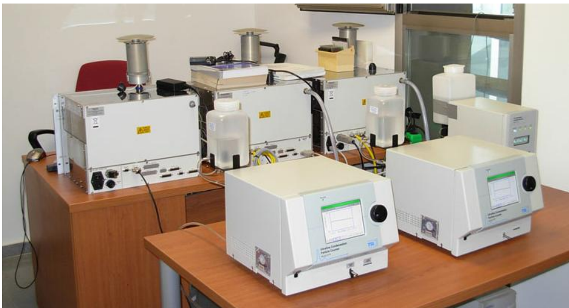
Fig. 3.3. Superior) Fotografía de los 3 CPCs y 3 MAAPs que participaron en la inter-comparación realizada en la Universidad de Huelva entre el 1 y 4 de Abril de 2008 en el marco del proyecto EPAU. Inferior) imagen de los CPCs, modelos 3776 (centro e izquierda) y 3785 (derecha).
