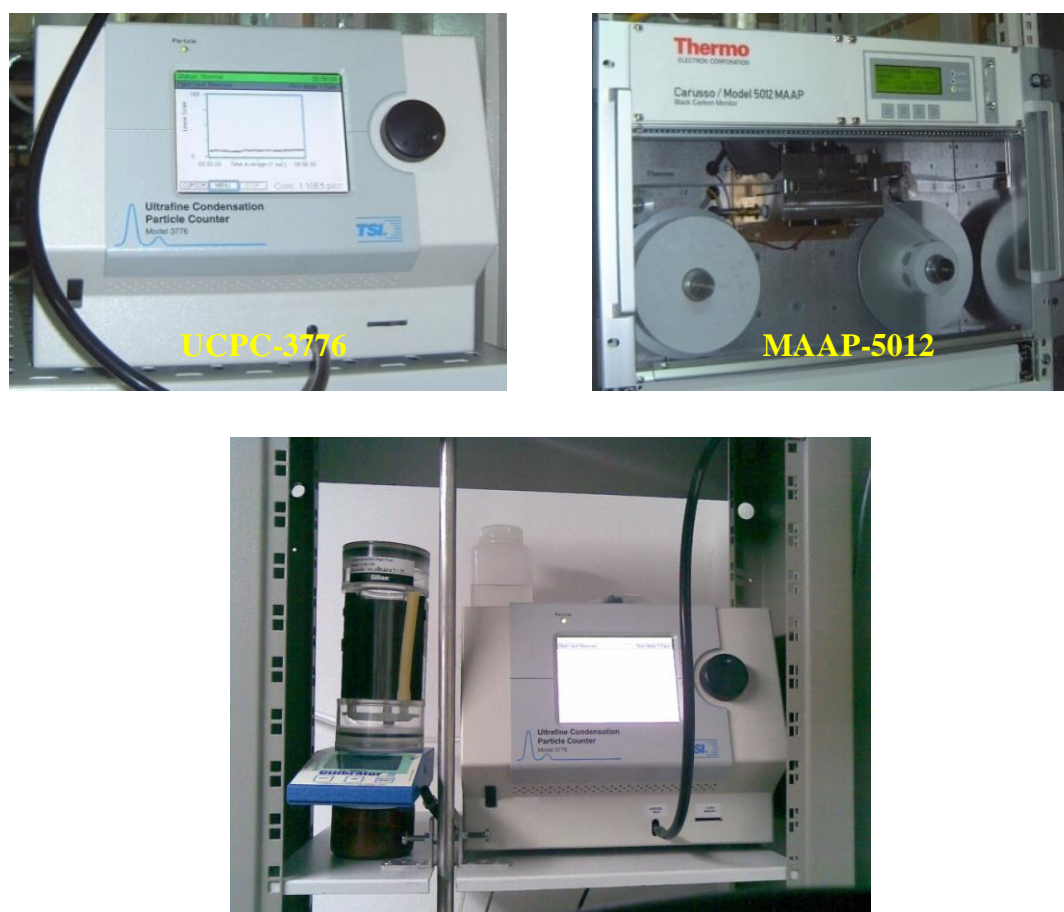
Fig. 3.2. Superior) UCPC-3776 y MAAP-5012 en la estación Campus Universitario. Inferior) Caudalímetro Gilibrator junto a un UCPC-3776.
