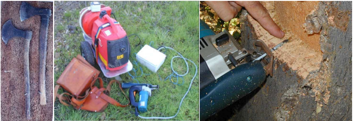
Fotografía 6.9. Viejas y nuevas herramientas del descorche Hachas corcheras y máquina electromecánica de descorche
