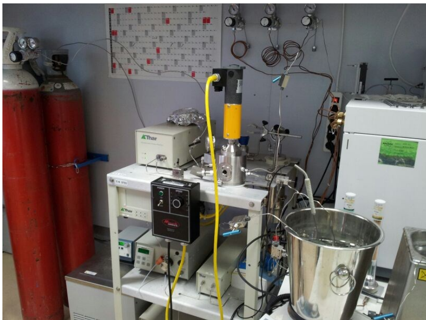
Figura 5. Dispositivo experimental para las reacciones en scCO_2 .
