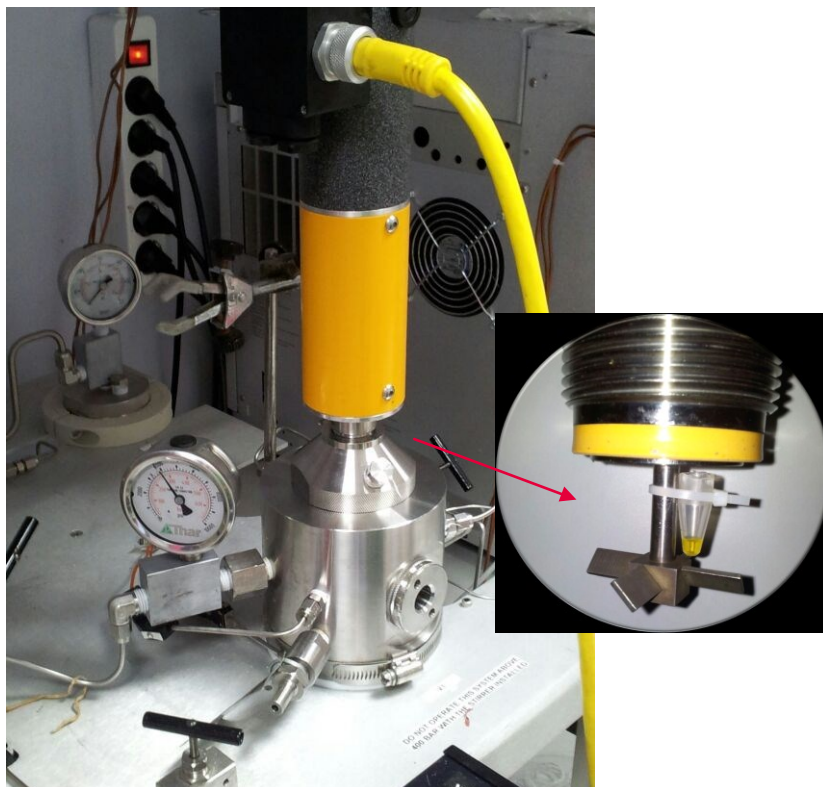
Figura 7. Reactor presurizado a 250 atm con \text{CO}_2 y metano en el que se coloca el recipiente con EDA, y al que se transfiere el Au(I) disuelto proveniente de la columna.
