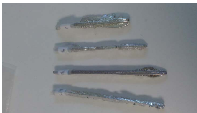
Figura 4. Barras de los diferentes metales y aleaciones obtenidas tras verter granalla fundida en un molde tallado sobre un ladrillo refractario.
