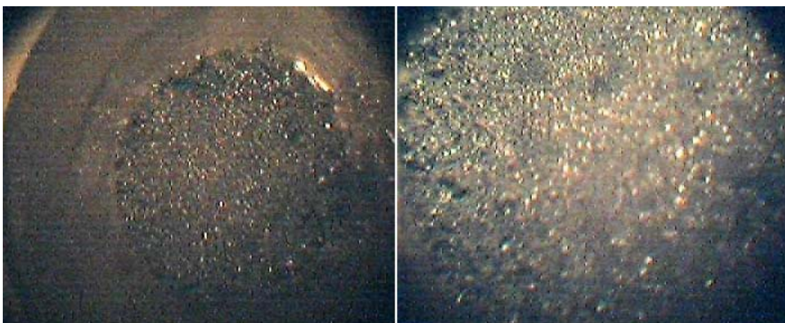
Figura 11. Fotografías que muestran el estado de la superficie de zinc tras el proceso de electrodeposición. La imagen de la izquierda muestra la superficie aumentada 40 veces, y la de la derecha, 90 veces.
