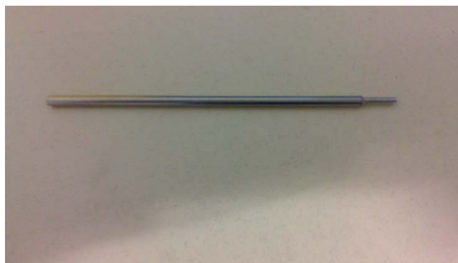
Figura 5. Barra de acero inoxidable empleada en la fabricación de los electrodos en los que se realizarán las pruebas de electrodeposición.
