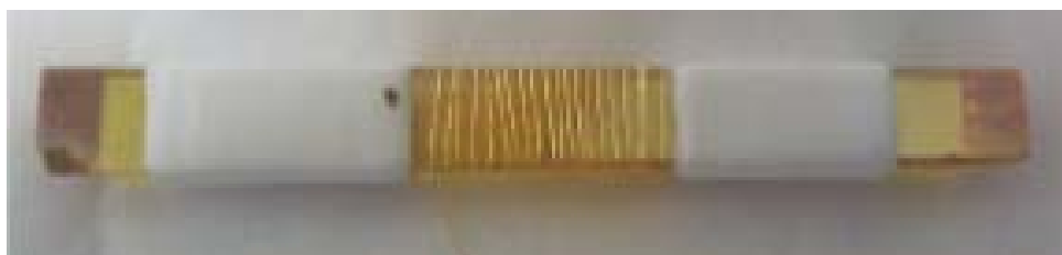
Figura 53. Electrodo de oro en espiral con poros a escala nanométrica realizados mediante anodización a diferentes pH [462].
