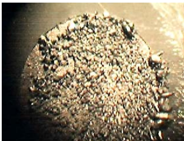
Figura 17. Fotografía que muestra el estado de la superficie de plomo tras el proceso de electrodeposición en el que se emplea ácido cítrico como aditivo para mejorar la calidad de la superficie electródica. La imagen muestra un aumento de 50 veces el tamaño real.
