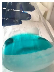
Figura 69. Precipitado blanco en la experiencia A4 del ensayo A (1.00 g L -1 Bi y 9.40 g L -1 As) formado en el quinto día.
