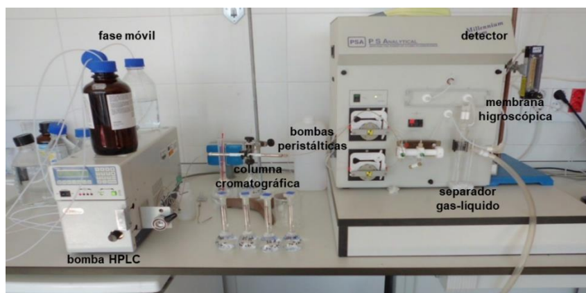
Figura 38. Acoplamiento HPLC-HG-AFS especiación de As y Sb.
