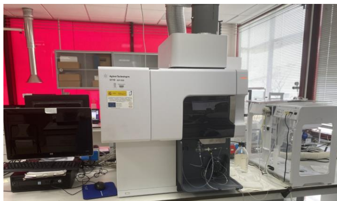
Figura 42. Plasma de acoplamiento inductivo-espectrometría de emisión atómica (ICP-AES).
