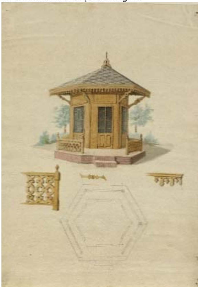
Figura 8. Proyecto de construcción de un quiosco hexagonal.
