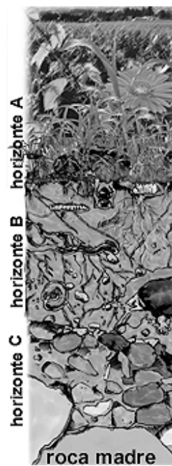
Figura 1.10. Ilustración esquemática del perfil de un suelo con sus horizontes principales.
