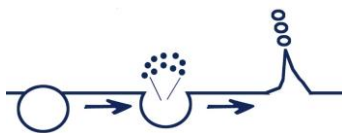
Fig. 8. Descripción gráfica del mecanismo bubble bursting para la formación de spray marino.
