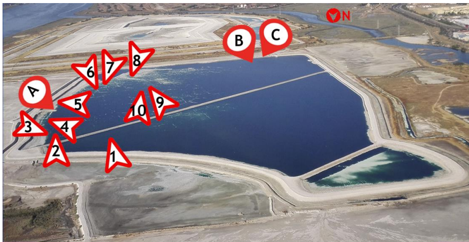
Fig. 14. Puntos de muestreo de sales bandeadas y PG: AS0 (1); AS1 (2); AS2 (3); AS3 (4); AS4 (5); AS5 (6); AS6 (7); AS7 (8); PG+AS1 (9); PG+AS2 (10). Puntos de muestreo de salmueras: A, B y C.
