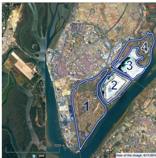
Fig. 10. División administrativa del depósito de PG. Zonas 1 y 4: áreas restauradas. Zona 2: pirámide de fosfoyesos. Zona 3: balsa de evaporación.
