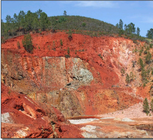
Figura 2. Panorámica de una pared de la corta. La parte central de la foto de color gris se corresponde con la mineralización de sulfuros, cuyo detalle se puede ver en la Fig.3. En la parte superior se observa una montera de oxidación.
