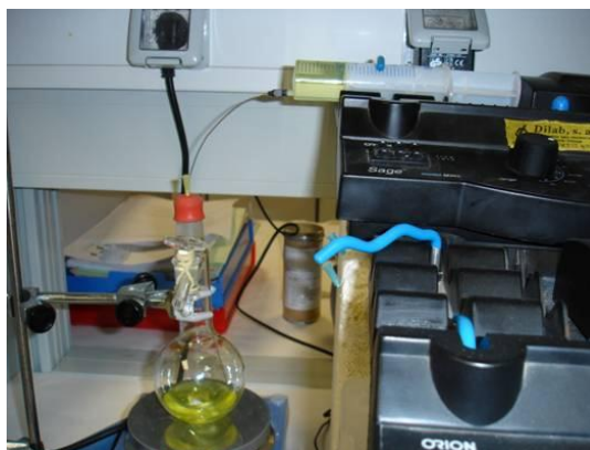
Figura 19. Matraz con agitación magnética y jeringa automática como sistema de adición.
