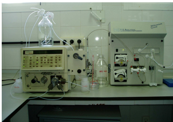
Figura 3.13.- Acoplamiento instrumental de Cromatografía Líquida de Alta Resolución, Generación de Hidruros y Espectrometría de Fluorescencia Atómica (HPLC-HG-AFS) para la determinación de las especies As (III) y As (V).
