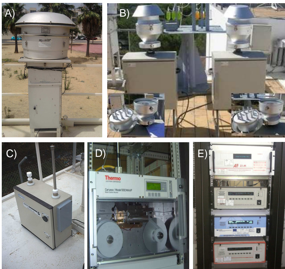
Figura 3.7.- Resumen de los analizadores y equipos empleados en el muestreo de gases contaminantes y material particulado en este estudio A) Captador de alto volumen Graseby-Andersen, B) Captador de alto volumen MCV PM1025-CAV, C) Espectrómetro láser GRIMM, D) Equipo de atenuación Beta, E) Analizadores de CO, NO x , SO 2 y O 3 .
