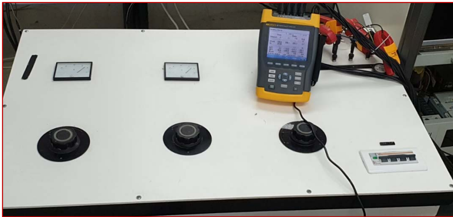
Figura B.2. Fuente variable trifásica utilizada para modificar el nivel de desequilibrio de tensiones (Fuente B ).
