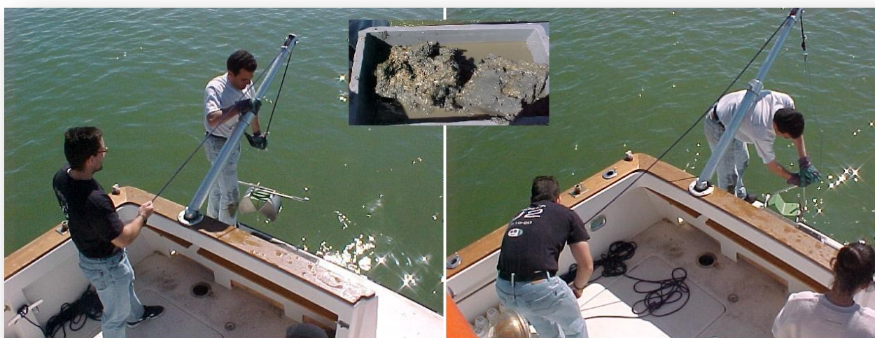
Figura 25. Imagen de toma de muestra de sedimento superficial en zona submareal mediante draga Van Veen.
