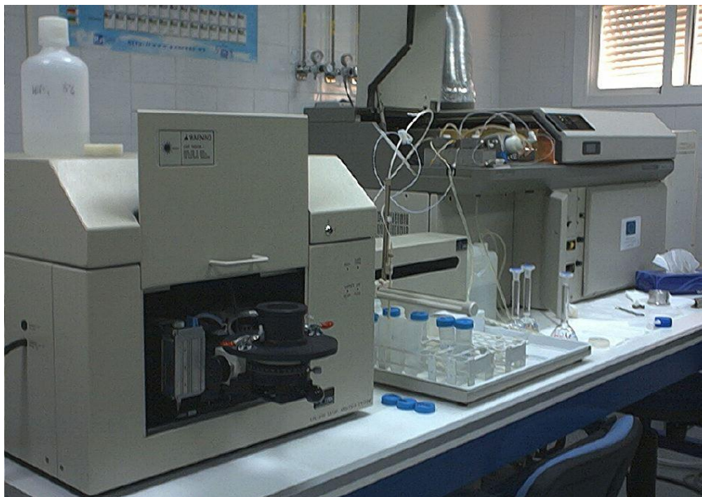
Figura 29. Detalle de la cámara de ablación, automuestreador y cuerpo principal del ICP-MS de los Servicios Centrales de I+D de la Universidad de Huelva.
