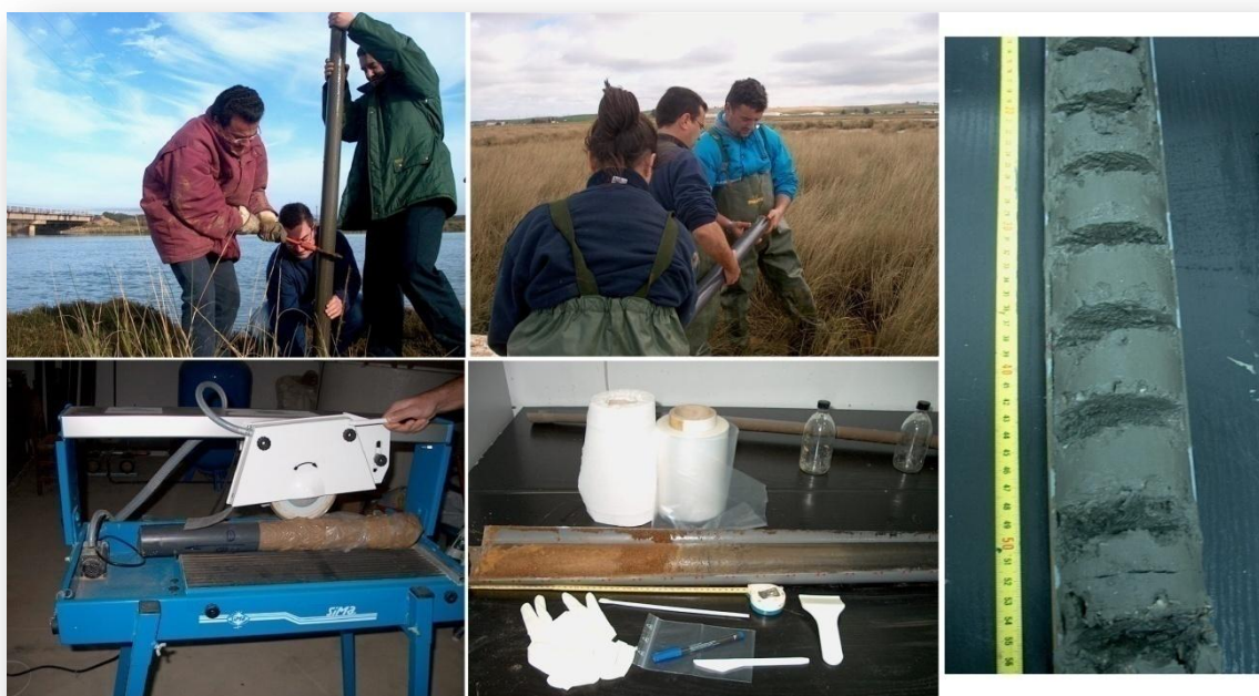
Figura 26. Imágenes de testificación y apertura de testigos cortos.
